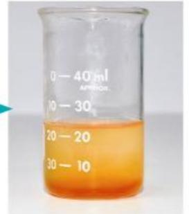
formation d'un précipité de rouille d'hydroxyde ferrique  $\text{Fe}(\text{OH})_3$
