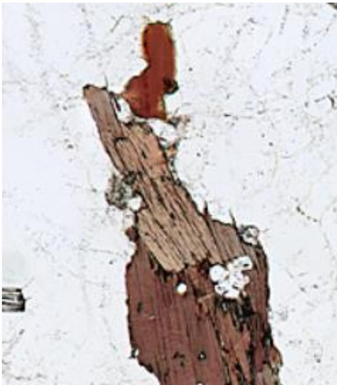
**Photographie au microscope polarisant (LPNA) de minéraux de biotite (bruns, clivage) dans un granite**
